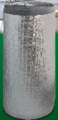
Las membranas DOBLE ALU aíslan térmicamente por masa y reflexión. Poseen un espesor de 5, 10 ó 15 mm de espuma de polietileno, cuya estructura de celda cerrada es de baja conductividad térmica (aislante de masa) e impermeable al agua y al vapor. Además incorpora un foil de aluminio puro en ambas caras. Este foil de baja emisividad, refleja en verano el calor radiante que emite la chapa al interior del galpón. El foil de la cara opuesta protege la integridad de la membrana.
